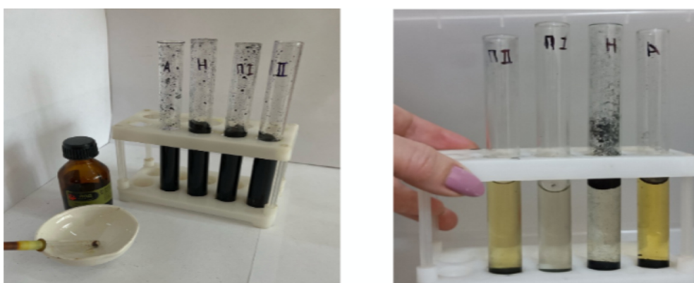
Рис. 7. Определение йодного числа
