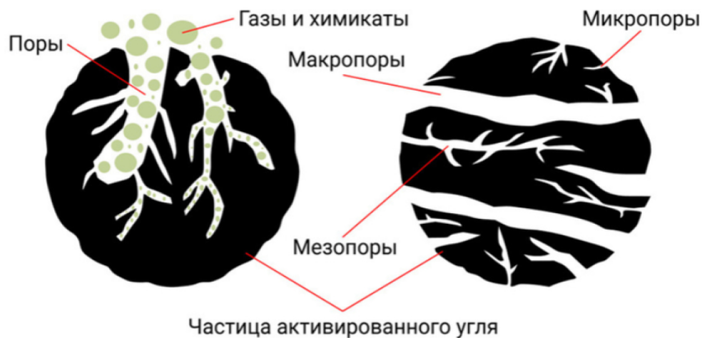
Рис. 2. Механизм адсорбции активированным углем
