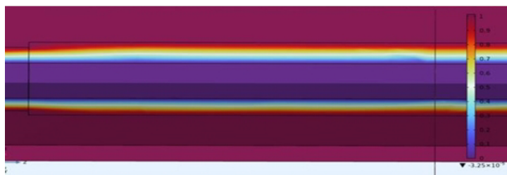
Рис. 9. Картина растекания поля для провода с дефектом «Локальное утолщение»
