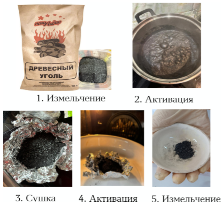
Рис. 4. Стадии производства собственного активированного угля»
